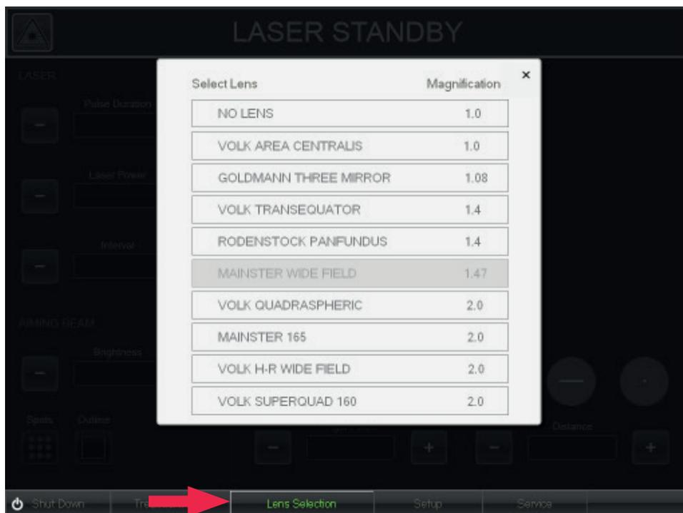
Sélectionner le verre de contact approprié pour voir la taille réelle du spot sur la rétine. La taille réelle du spot a également une incidence sur les valeurs de fluence et de surface totale traitée. Les verres disponibles sont présentés ci-dessous.
