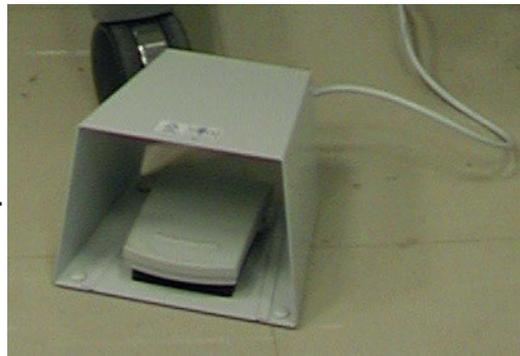
Si la pédale reste enfoncée une fois le pattern tracé, le système interrompt la coagulation. Pour produire un nouveau pattern laser, il est nécessaire de relâcher la pédale puis d'appuyer à nouveau dessus.
