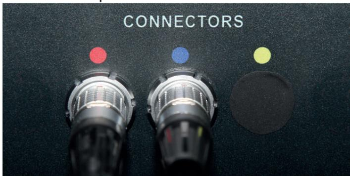
Raccordements de l'adaptateur pour lampe à fente à la console
