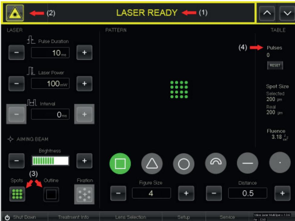
Lorsque le laser est activé, le point de visée est actif et dessine le contour du pattern choisi ou en affiche tous les spots. Le laser de traitement est prêt et contrôlable via la pédale.
