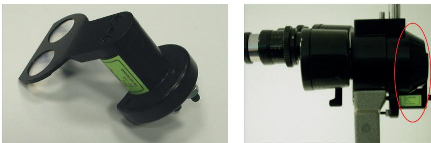
Pour les modèles Haag-Streit BQ (gauche) et CSO 990 (droite), le filtre annulaire est situé entre le microscope et les binoculaires.
