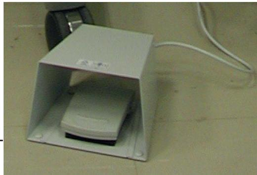
Si el pedal sigue pisado una vez dibujado el patrón, el sistema no continuará con la coagulación. Para producir un nuevo patrón del láser, es necesario soltar y volver a pisar el pedal.
