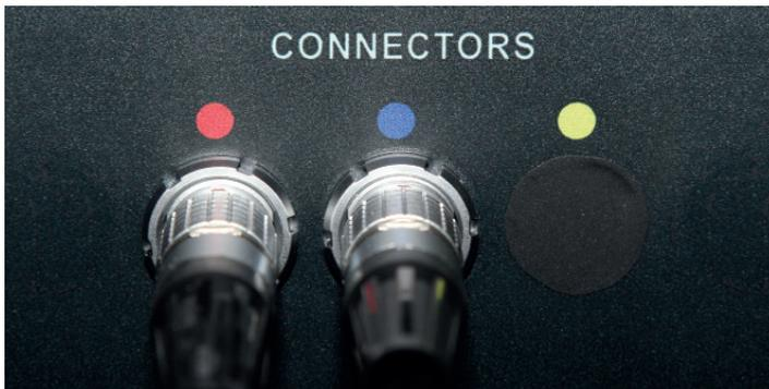
Conexiones del SLA a la consola
