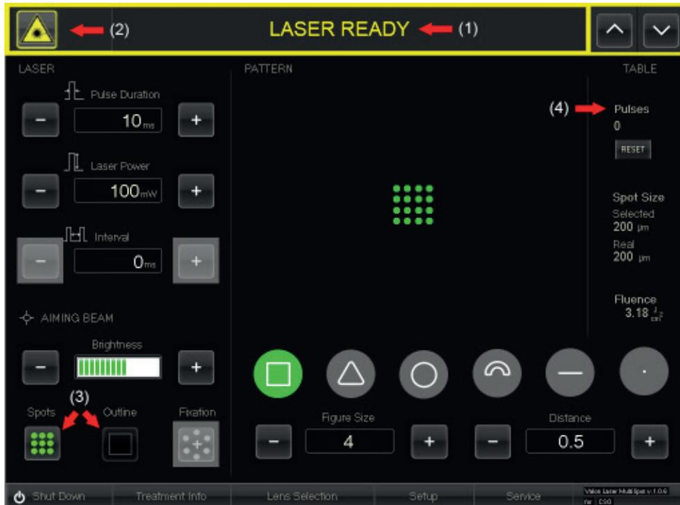
Cuando el láser está activado, el punto de impacto se habilita y dibuja el contorno o muestra todos los spots del patrón seleccionado. El láser de tratamiento está listo y se puede controlar mediante el pedal.
