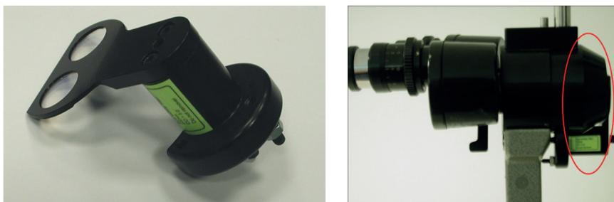
En los modelos Haag-Streit BQ (izquierda) y CSO 990 (derecha), el filtro con forma de anillo está situado entre el microscopio y los binoculares.
