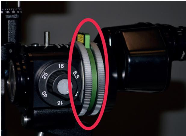
1. Compruebe que el filtro de seguridad ocular está instalado.
